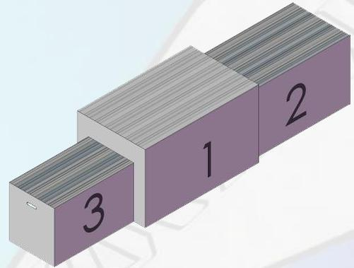
La estructura se recubre con una chapa de aluminio que tiene un vaciado a cada lado que facilita su traslado. En las partes superiores disponen chapas de aluminio Damero (chapa con pequeños relieves) a modo de suelo, que además de darle una gran estética, hará que la superficie sea antideslizante. Son apilables y se pueden recoger uno de otro, así que no ocupan gran superficie.
