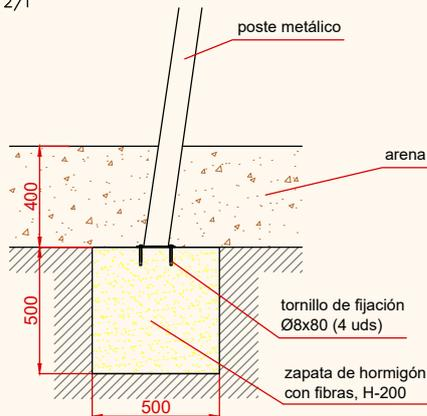
ESQUEMA DE CIMENTACIÓN EN HORMIGÓN
