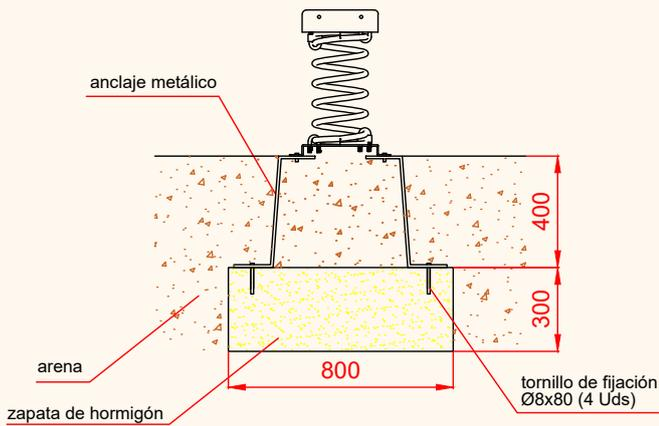
ESQUEMA DE CIMENTACIÓN EN HORMIGÓN
