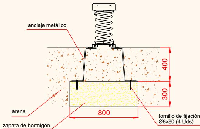
ESQUEMA DE CIMENTACIÓN EN HORMIGÓN
