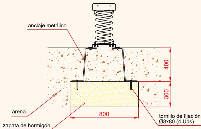
ESQUEMA DE CIMENTACIÓN EN HORMIGÓN
