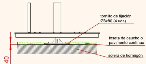
ESQUEMA DE CIMENTACIÓN EN HORMIGÓN VERSIÓN 2
