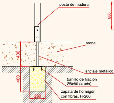
ESQUEMA DE CIMENTACIÓN EN HORMIGÓN E: 2/1
