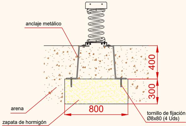
ESQUEMA DE CIMENTACIÓN EN HORMIGÓN
